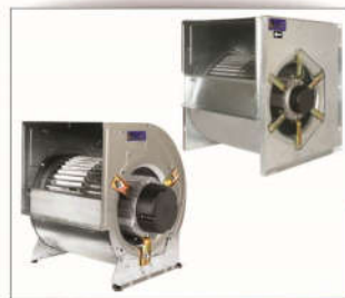
▶ VENTILATEUR CENTRIFUGE ACCOUPLEMENT DIRECT Turbine double aspiration à action Débit d'air max. : 10 800 m 3 /h Moteur à 1 vitesse monophasé 230 V, triphasé 230/400 V, 4P et 6
