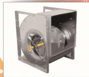
▶ VENTILATEUR CENTRIFUGE TRANSMISSION POULIE/COURROIE Turbine double aspiration à réaction Débit d'air max. : 60 000 m 3 /h Turbine sur axe et paliers Plusieurs variantes de construction
